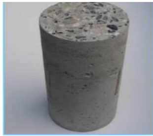
Χρήση υαλοποιημένου υπολείμματος ως πρόσθετου στο μπετό
